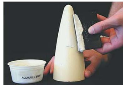
Nachdem der Kern geformt und in einem Konvektionsofen getrocknet wurde kann Aquafill problemlos z.B. mit einem Gummi- oder Kunststoffspachtel aufgebracht werden. Aquafill lässt sich nicht ganz so schnell auswaschen wie Aquacore oder Aquapour - ist jedoch absolut umweltfreundlich und erfordert keine speziellen Entsorgungsverfahren.
